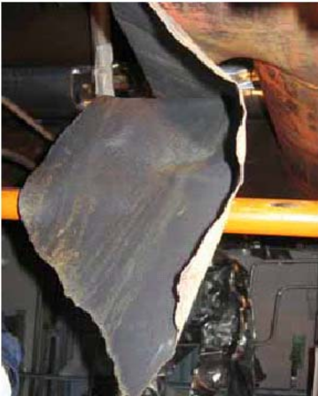
図2 0.6mmまで減肉し破断した配管
